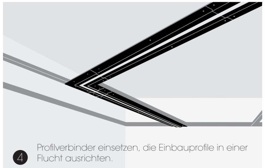
4 Profilverbinder einsetzen, die Einbauprofile in einer Flucht ausrichten.
