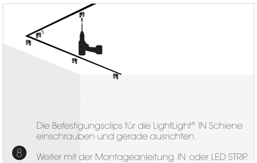
8 Die Befestigungsclips für die LightLight® IN Schiene einschrauben und gerade ausrichten.
