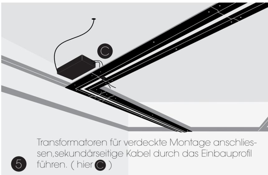
5 Transformatoren für verdeckte Montage anschließen, sekundärseitige Kabel durch das Einbauprofil führen. ( hier C )
