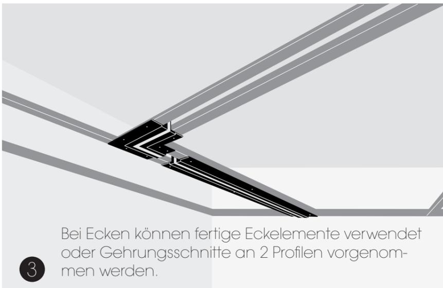
3 Bei Ecken können fertige Eckelemente verwendet oder Gehrungsschnitte an 2 Profilen vorgenommen werden.
