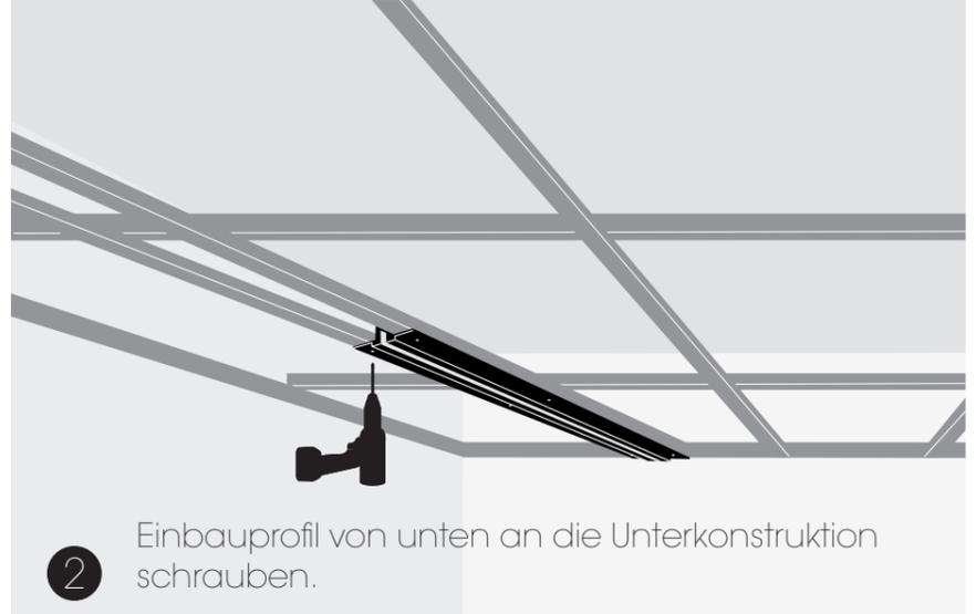
2 Einbauprofil von unten an die Unterkonstruktion schrauben.
